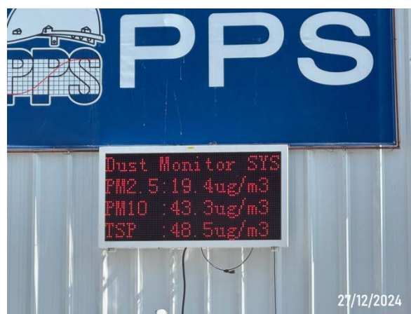
รูปที่ 2-14 จอแสดงผลค่า PM2.5 และ PM10 แบบเรียลไทม์
